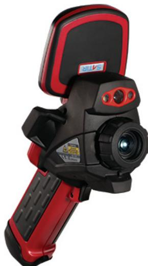
Тепловизор HotFind-L - инфракрасная камера с матрицей 384x288 для применения при обследовании зданий до 12...14 этажей, электрооборудование до 110 кВ, котельные и тепломеханическое оборудование. В приборе реализована технология DUO-VISION Plus которая позволяет наложить тепловое изображение на видимое для лучшей детализации общей картины и более качественного анализа.
