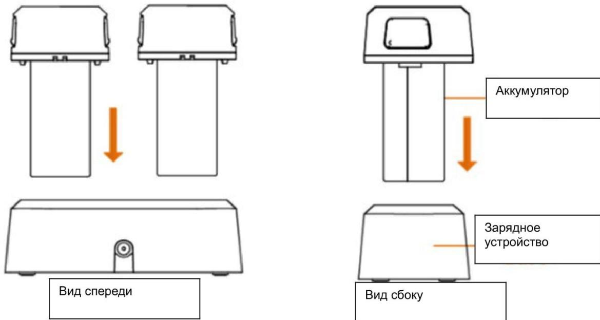
Когда аккумулятор полностью зарядится, извлеките его из зарядного устройства.
